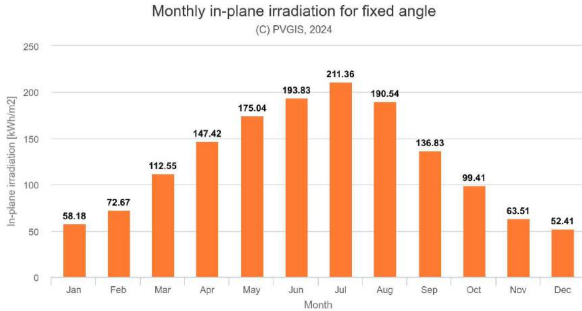
Слика 3. Просечна ирадијација при фиксен агол за дадената локација изразена во kWh/m 2
